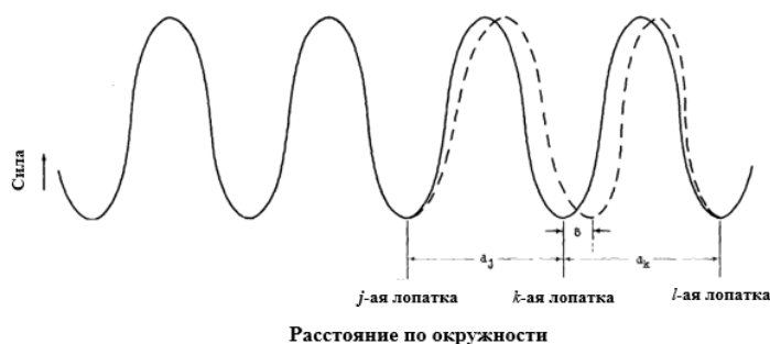
Рисунок 1 – Обозначение смещения лопаток в расчете коэффициента влияния
