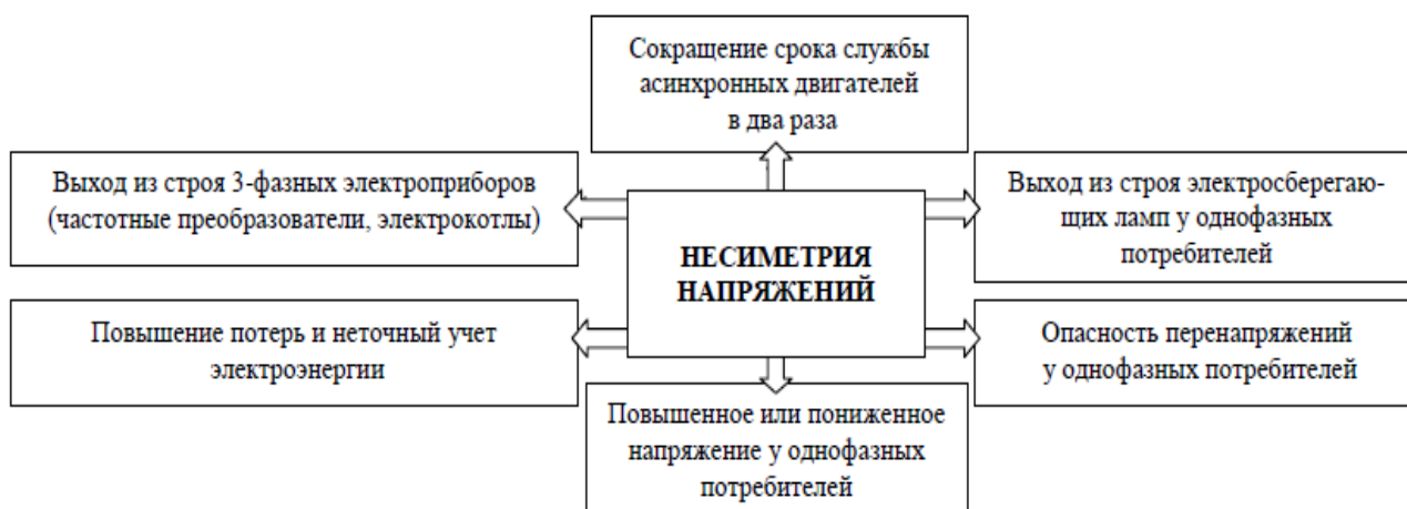
Рисунок 2-Последствия несимметрии напряжения
